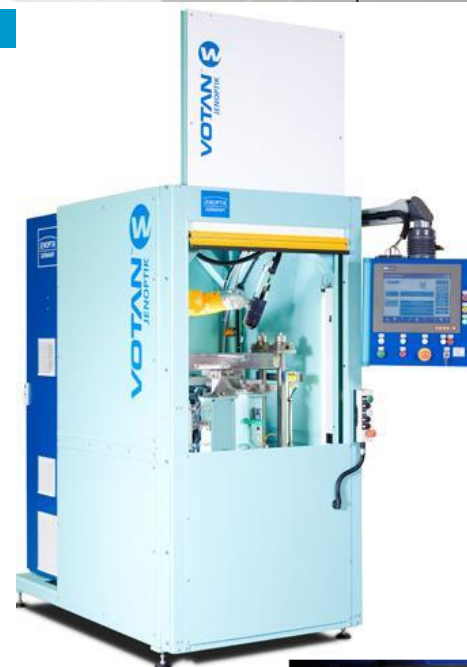
Установка для лазерной резки 3D-деталей из пластмассы JENOPTIK-VOTANTMC BIM
