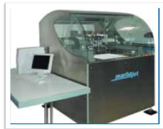
Установка резки струей воды высокого давления Marbajet
