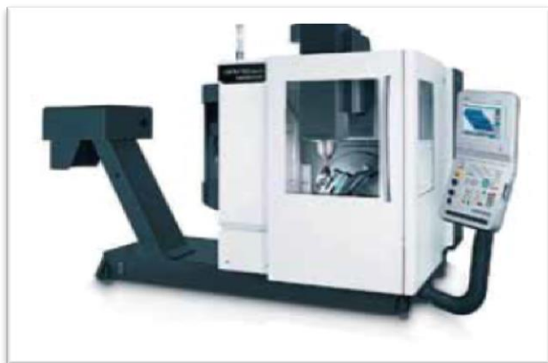
Универсальный 5-осевой обрабатывающий центр с ЧПУ производства фирмы DMG
