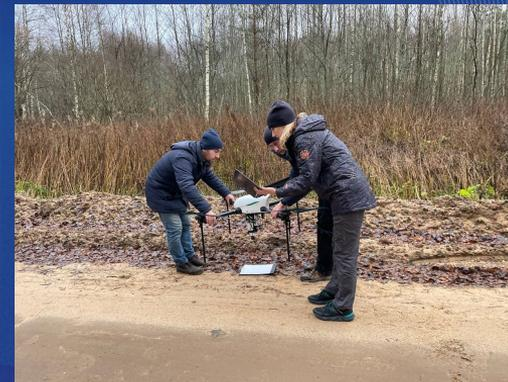
Для выполнения ВЛС использовался мобильный лазерный сканер Luftera LS-100. Гиперспектральная съемка выполнялась при помощи гиперспектральной камеры Cubert S185. Спектральный диапазон составляет 450-950 нм, количество спектральных каналов - 125.
