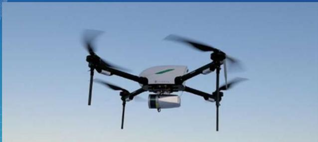
Воздушное лазерное сканирование (ВЛС, лидар) и гиперспектральная съемка выполнялись с беспилотного воздушного судна (БВС) Luftera LQ-5
